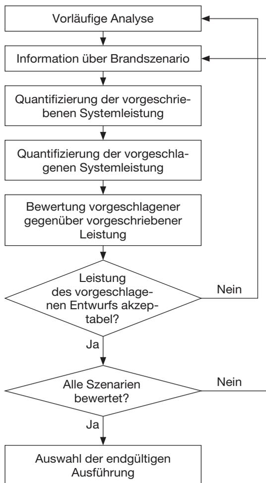
**Abbildung 6.4.1 Ablaufdiagramm Alternative Ausführungen und Anordnungen**
